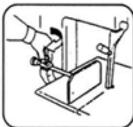
4. Levante el bloque de presión como se muestra en los diagramas E y F. Coloque el alimento a procesar cerca del tope para carne con la mano derecha y empuje el alimento hacia la banda de sierra a través del bloque de presión (la velocidad de presión varía según el alimento y se basa en el funcionamiento normal de la banda de sierra como limitación). Repita la operación hasta que se complete el corte. Luego apague el suministro de energía
