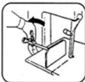
2. Confirme el grosor de corte ajustando la distancia entre los topes de carne delantero y trasero y la sierra de banda.
