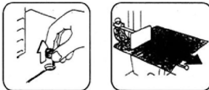
4. Levante hacia arriba y hacia afuera para desmontar la rueda superior.
