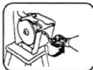
3. Retire el impulsor guía y desmonte la bandeja de transporte.
