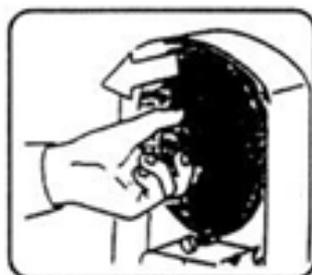
5. Extraiga la rueda inferior con ambas manos uniformemente liberando la placa de presión del extremo del eje. En caso de dificultad para removerla, utilice el dispositivo de desmontaje debajo de la bandeja de transporte para desmontar fácilmente el dispositivo de sujeción vertical de la rueda inferior, como se muestra en el Diagrama EH. Después de completar la limpieza, vuelva a ensamblar el conjunto siguiendo los procedimientos inversos.
