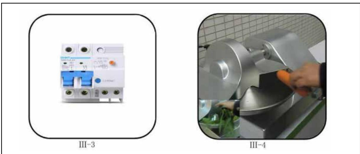
5. Enciende el suministro de energía y presiona el botón verde de arranque. La máquina funcionará automáticamente, con la luz indicadora encendida, el eje principal y la bandeja de alimentos en funcionamiento.
