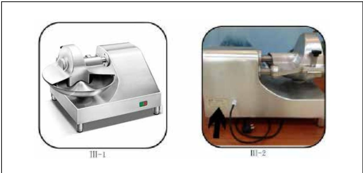
3. Es necesario instalar un protector de fugas delante del enchufe de alimentación. La corriente nominal no debe ser menor de 32A. La corriente de acción no debe exceder los 30mA, y el tiempo de acción no debe superar los 0,1 segundos. Asegúrate de que el cable de tierra esté correctamente conectado.
