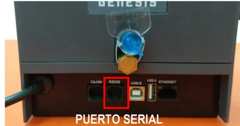
**IMPORTANTE:** El conector SERIAL y el conector para la gaveta usan el mismo tipo de conector. **Preste extrema atención donde conecta el cable serial.**
