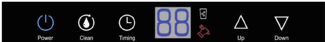
La pantalla digital muestra la temperatura ambiente, la hora de hacer hielo, la limpieza, temporizador de cuenta atrás del ciclo y retraso en tiempo para la fabricadora de hielo.
