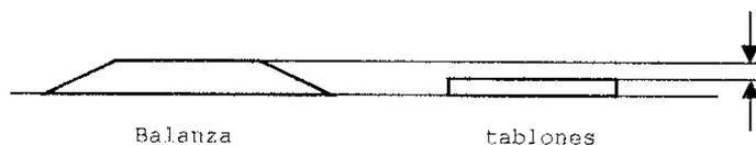
Si el eje que se está pesando en la balanza queda más alto que los otros ejes del camión, el valor de Kg. leído en el indicador digital de la balanza es mayor que el real (pesa de más).
