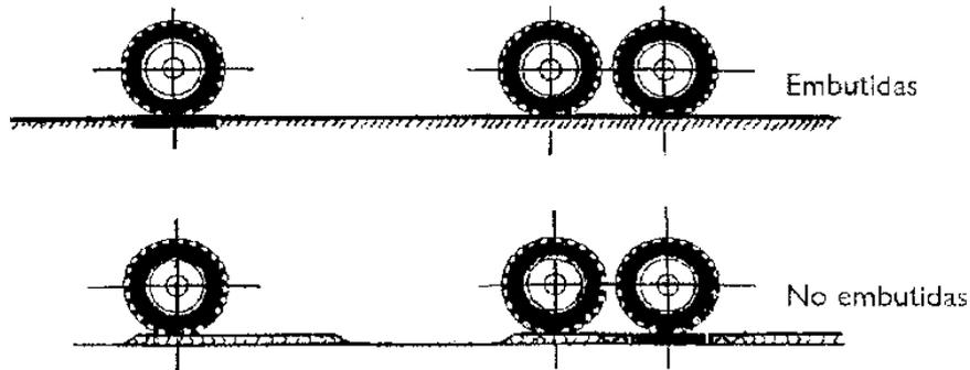
b) Para el caso de utilización de las plataformas de manera "No embutidas", emplear tablonés previa y posteriormente a la báscula (ver dibujo).
